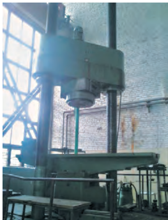
Рисунок 3.13 – Испытательная машина ЦД 20/400 ПУ
