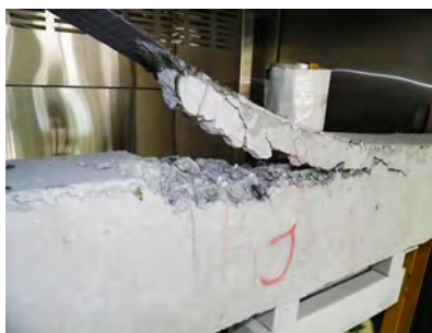
Рисунок 4.5 – Вид балок серии «Б» подгруппы «охлаждение» до и после испытания на прочность на изгиб при температуре -60^{\circ}\text{C}
