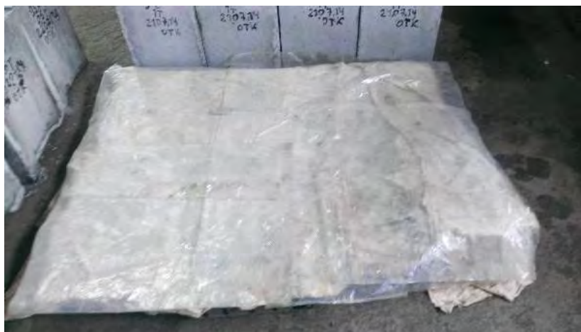
Рисунок 4.20 — Хранение образцов в нормальных условиях до распалубки
