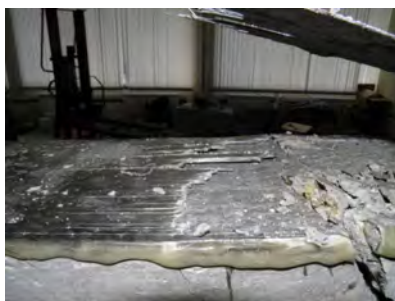
Рисунок 4.9 – Вид балок серии «Б» подгруппы «нагрев» после испытаний на прочность при температуре +60 °С
