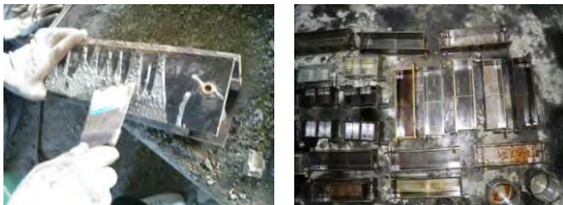
Рисунок 4.19 — Очистка и смазка форм перед бетонированием очередной партии образцов
