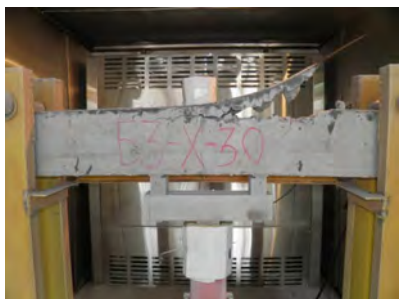
Рисунок 4.6 – Вид балок серии «Б» подгруппы «охлаждение» до и после испытания на прочность на изгиб при температуре -30^{\circ}\text{C}
