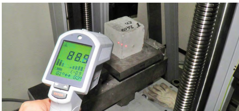
Рисунок 4.24 – Пример тепловизионной съемки образцов, предварительно нагретых до +90\text{ }^{\circ}\text{C}
