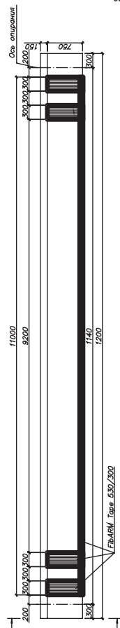
Балка L = 12,0 м Балка, усиленная холстом FybARM Tape 530/300 (серия "Б")
