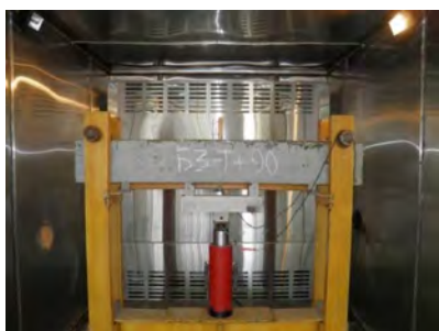
Рисунок 4.10 – Вид балок серии «Б» подгруппы «нагрев» после испытаний на прочность при температуре +90^{\circ}\text{C}
