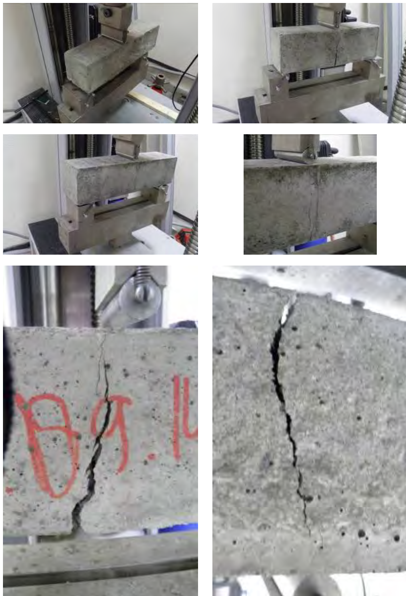
Рисунок 4.25 — Вид образцов-призм из второго состава бетонной смеси после испытания на прочность на изгиб
