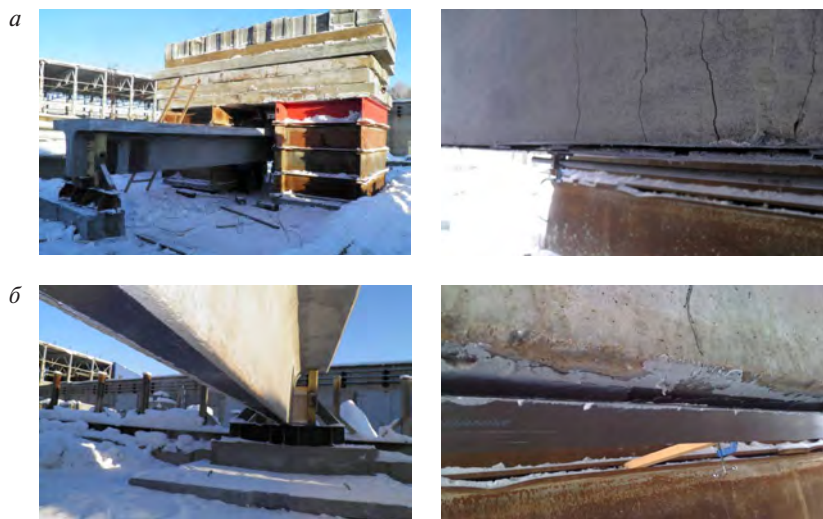
Рисунок 3.8 – Общий натуральный вид усиленных балок серии «В» после испытания на прочность на изгиб длиной: а – 12 м; б – 20 м
