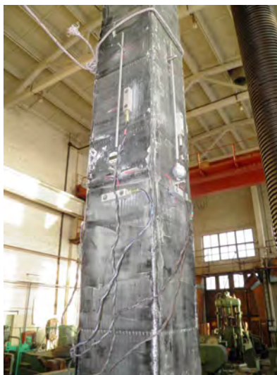
Рисунок 3.17 – Натурный вид колонн серии «Б», усиленных холстами на основании углеродных волокон, подвергшихся испытаниям на сжатие
