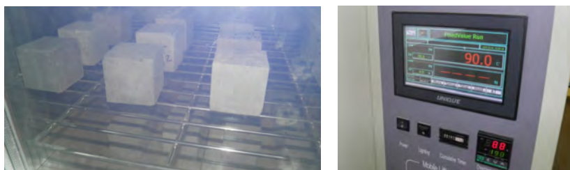
Рисунок 4.23 – Пример выдержки бетонных образцов в определенных температурных условиях
