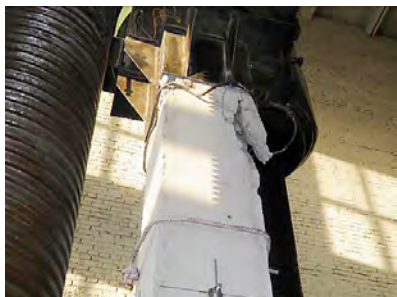
Рисунок 3.16 – Вид неусиленных колонн серии «А», подвергшихся испытаниям на прочность на сжатие в месте локального разрушения
