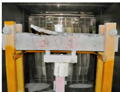
Рисунок 4.5 – Вид балок серии «Б» подгруппы «охлаждение» до и после испытания на прочность на изгиб при температуре -60^{\circ}\text{C}
