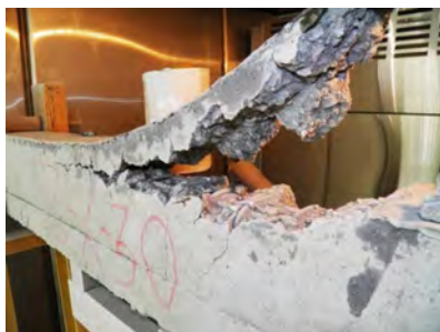
Рисунок 4.6 – Вид балок серии «Б» подгруппы «охлаждение» до и после испытания на прочность на изгиб при температуре -30^{\circ}\text{C}
