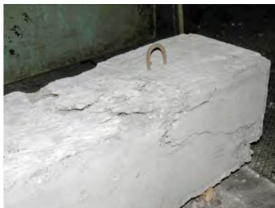
Рисунок 3.16 – Вид неусиленных колонн серии «А», подвергшихся испытаниям на прочность на сжатие в месте локального разрушения
