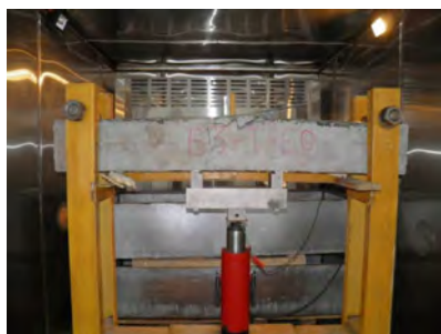
Рисунок 4.9 – Вид балок серии «Б» подгруппы «нагрев» после испытаний на прочность при температуре +60 °С
