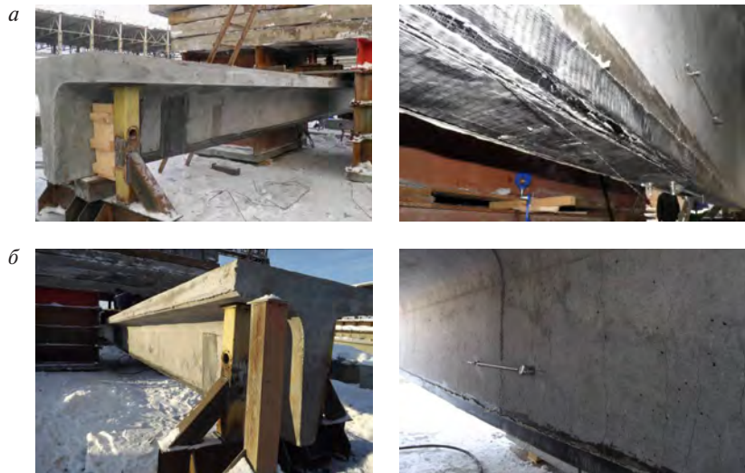
Рисунок 3.7 – Общий натуральный вид усиленных балок серии «Б» после испытания на прочность на изгиб длиной: а – 12 м; б – 10 м
