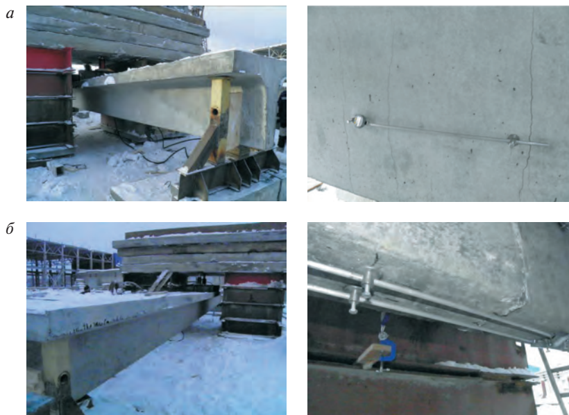
Рисунок 3.6 – Общий натуральный вид балок серии «А» после испытания на прочность на изгиб длиной:
