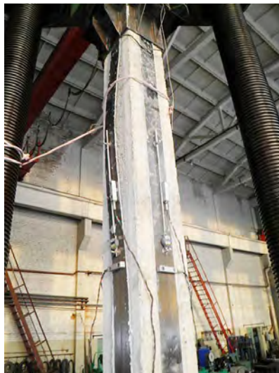
Рисунок 3.18 – Общий вид колонн серии «В», усиленных ламелями (без хомутов), подвергшихся испытаниям на сжатие
