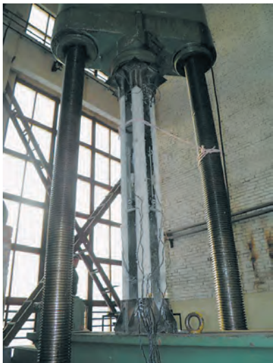
Рисунок 3.18 – Общий вид колонн серии «В», усиленных ламелями (без хомутов), подвергшихся испытаниям на сжатие
