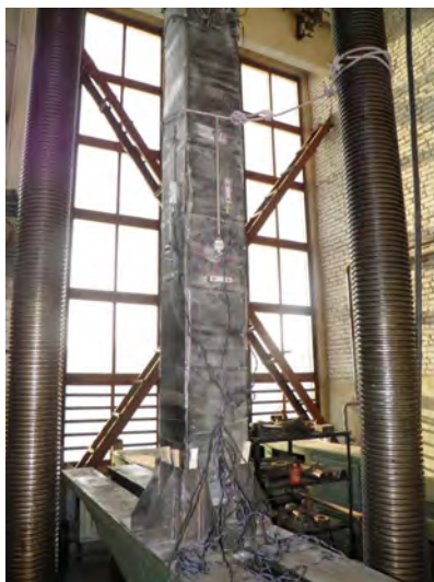
Рисунок 3.17 – Натурный вид колонн серии «Б», усиленных холстами на основании углеродных волокон, подвергшихся испытаниям на сжатие
