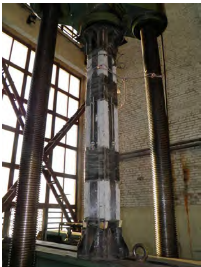
Рисунок 3.19 – Общий вид колонн серии «В», усиленных ламелями (с хомутами), подвергшихся испытаниям на сжатие
