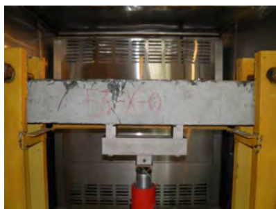
Рисунок 4.7 – Вид балок серии «Б» подгруппы «охлаждение» до и после испытания на прочность на изгиб при температуре 0 °С
