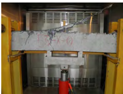
Рисунок 4.7 – Вид балок серии «Б» подгруппы «охлаждение» до и после испытания на прочность на изгиб при температуре 0 °С
