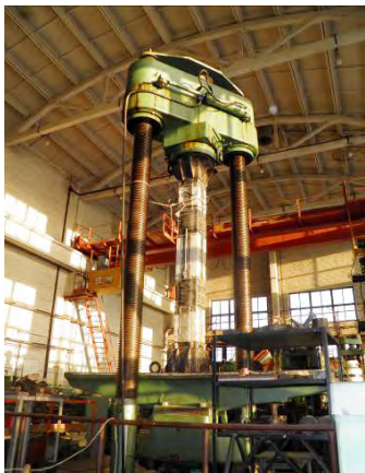
Рисунок 3.13 – Испытательная машина ЦД 20/400 ПУ
