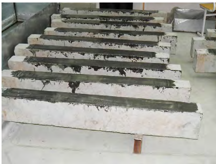
Рисунок 4.2 – Усиленные железобетонные балки
