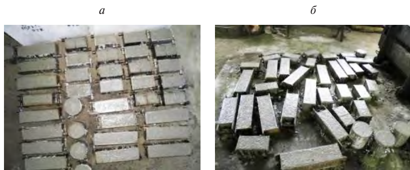
Рисунок 4.18 – Бетонирование образцов в специальных формах и емкостях: а – формы для бетонных образцов; б – образцы на вибростоле
