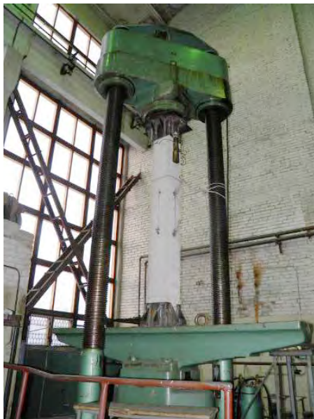
Рисунок 3.15 – Общий вид с фасада неусиленных образцов серии «А», подвергшихся испытаниям на прочность на сжатие
