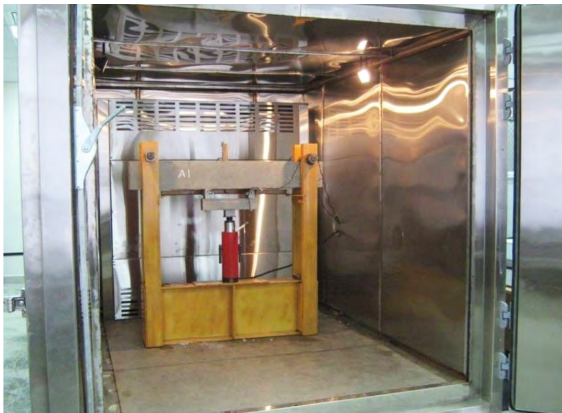
Рисунок 4.3 – Испытательный стенд с железобетонной балкой, установленный в климатическую камеру Techno 7010Wi
