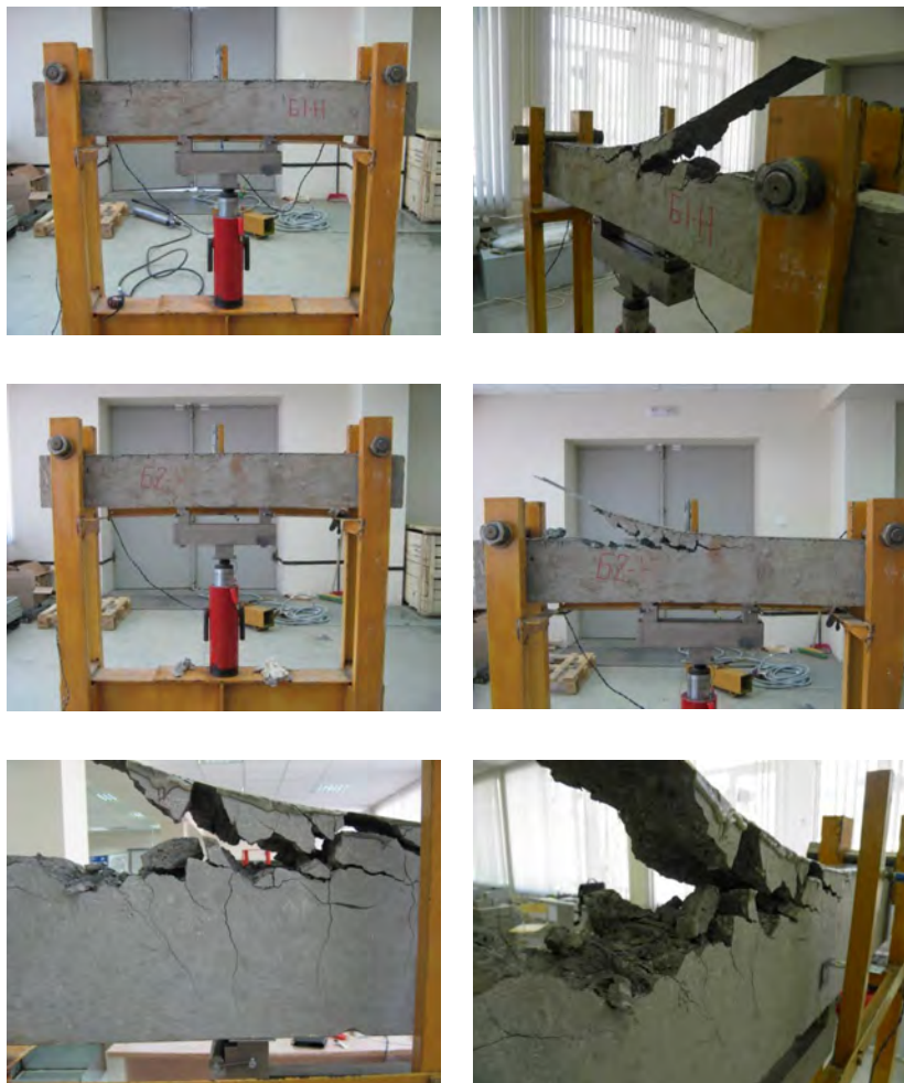
Рисунок 4.8 – Вид контрольных балок до и после испытания на прочность на изгиб при температуре +30^{\circ}\text{C}
